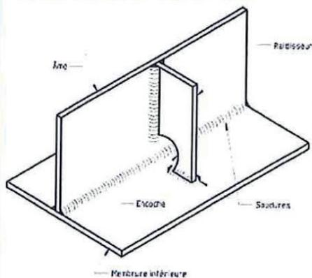
Pour les encoches,  $r \geq 50$  mm
